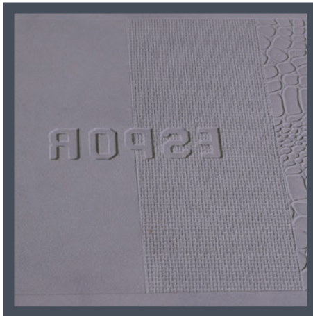
Von Portec produzierte poröse ESPOR® Form mit verschiedenen Strukturen „negativ“
